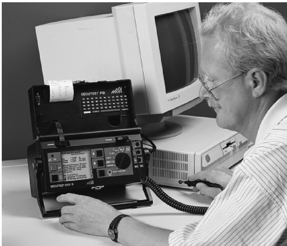
Bild 1: Wiederholungsprüfungen an einem PC mit dem Meß- und Prüfgerät SECUTEST 0701/0702
