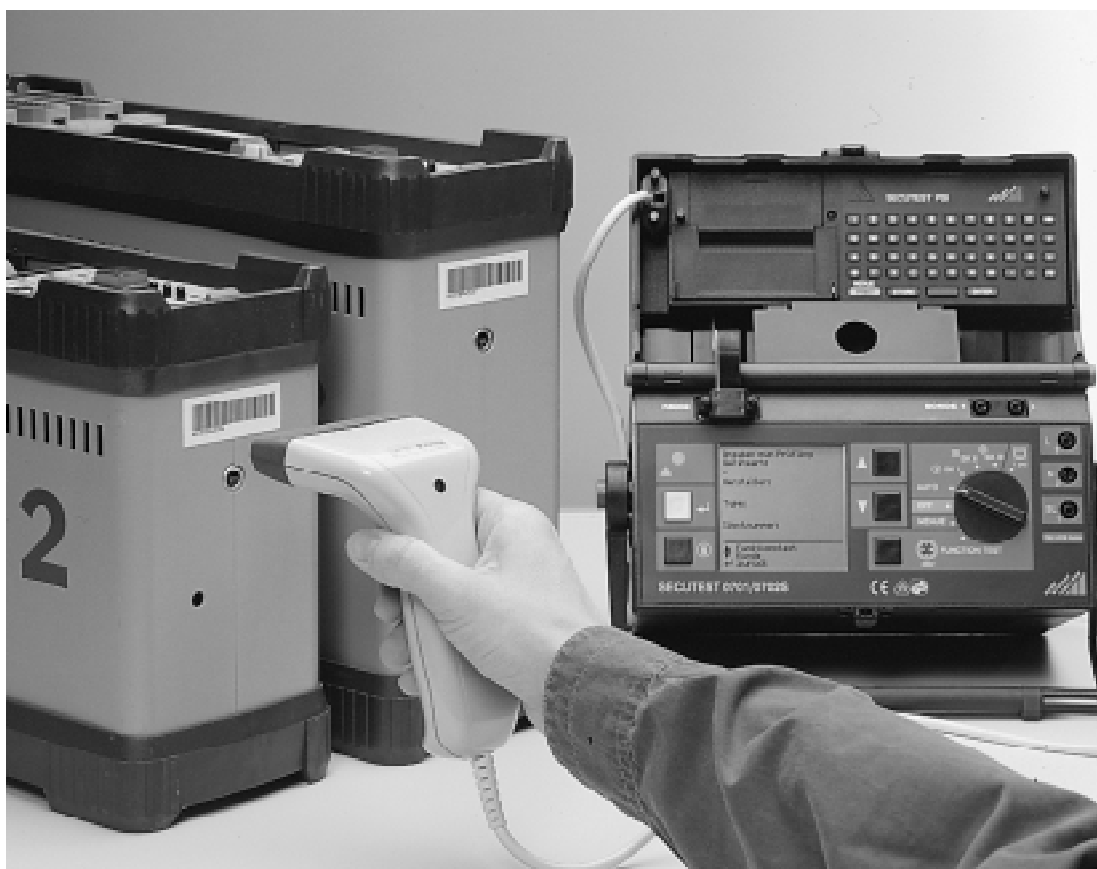
Bild 3: Die Eingabe der Identnummer kann durch einen Bar-Code Leser erfolgen
